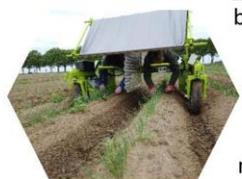
**Bineuse à guidage assisté électro-hydraulique:** La seule bineuse offrant une réponse instantanée et proportionnelle à la commande. D'une grande précision, elle associe puissance, finesse et souplesse; le tout sans pénibilité pour l'opérateur. Disponible de 2 à 4 rangs.
