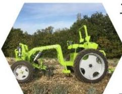
**Tract'Elec:** Tracteur porte outils 100% électrique, conçu idéalement pour le travail des planches en maraîchage. Ce porte outils apporte aux utilisateurs du confort (pas de bruits, pas de rejets de fumées ou de gaz dans les serres), de la fiabilité (pas de problèmes de démarrage) et surtout un usage économique (pas de vidange, pas de filtre à remplacer, pas de carburant, juste quelques euros de recharge d'électricité pour plusieurs heures de travail)
