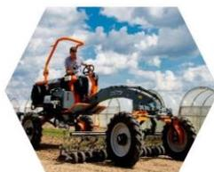
Notre porte outils CultiTrack a été conçu pour être une machine polyvalente au service des maraichers principalement pour les opérations de désherbage. Pensé pour une vision optimale des cultures, il peut accueillir des bineuses d'entretien et de précision. En fonction du modèle choisi, Il se destine aussi bien au maraîchage diversifié qu'aux cultures de plein champ.
